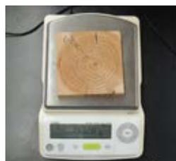
全乾法による含水率の計測
