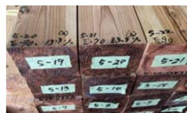
製材所の社内検査に合格した製材
