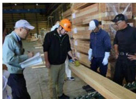
高周波式木材水分計による含水率の計測
